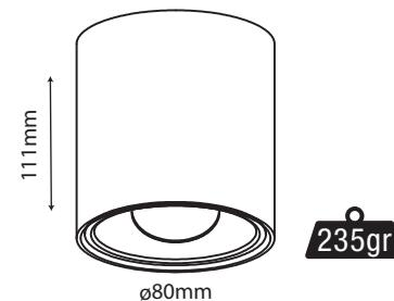
**IT** 1. Effettuare i collegamenti elettrici, quindi montare la base a muro, quindi la lampada GU10 nell'attacco e il diffusore a molla sulla lampadina. 2 - Finire il montaggio riavvitando il corpo lampada.
