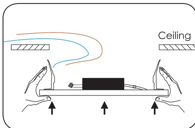
**IT** Collegare il LED Driver a corrente alternata di rete. Spingere il Pannello nella cavità del soffitto con le molle in rilievo.
