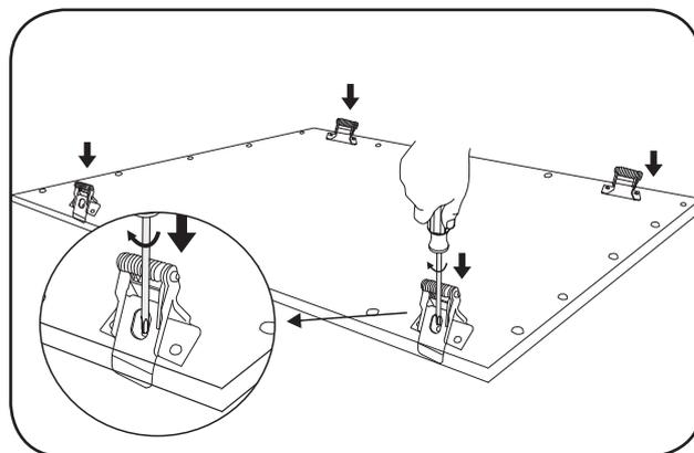
**IT** Posizionare le molle in posizione e reinstallare le quattro viti. (Le viti devono essere inserite attraverso il foro centrale della clip come sopra illustrato).
